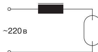
Рис. 31. Схема включения ртутных ламп высокого давления
