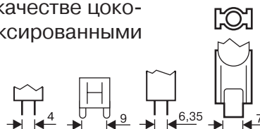
Рис. 15. Цоколи галогенных ламп накаливания
